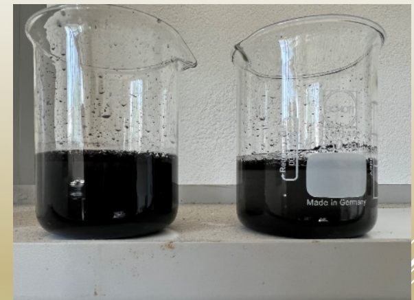
Fig. 1: Vista dei campioni di dispersione ad agitazione terminata. Sulla sinistra dispersione colloidale acqua- natural biochar -inerte colloidale; sulla destra dispersione natural biochar .
