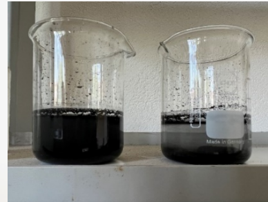
Fig. 2: Vista dei campioni di dispersione a riposo dopo circa 12 ore. Sulla sinistra dispersione colloidale acqua- natural biochar -inerte colloidale; sulla destra dispersione natural biochar .
