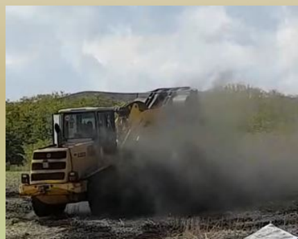
Fig. 2: Vista della diffusione delle polveri durante le fasi di caricamento del carrello per lo spandimento
