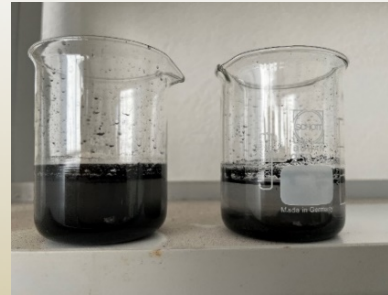
Fig. 3: Vista dei campioni di dispersione a riposo dopo circa 30 ore. Sulla sinistra dispersione colloidale acqua- natural biochar -inerte colloidale; sulla destra dispersione natural biochar .
