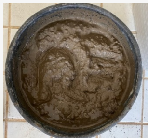
Fig. 1: Vista del Provino 1 al raggiungimento della condizione di saturazione
