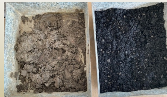
Fig. 1: Vista dei provini per la verifica in laboratorio dell'influenza del natural biochar sulla ritenzione idrica dei terreni
