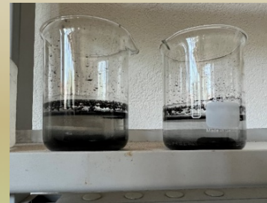
Fig. 4: Vista dei campioni di dispersione a riposo per circa 1 ora dopo la prima sedimentazione e successiva agitazione. Sulla sinistra dispersione colloidale acqua- natural biochar -inerte colloidale; sulla destra dispersione natural biochar .
